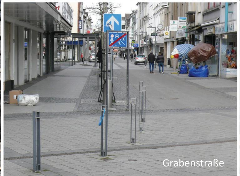
Die Fußgängerzone (Graben-, Neu- und Englerthstraße) sind mit einer ca. 3 m breiten Asphaltbahn, im Randbereich mit einem Plattenstreifen an den Häusern (Ladenlokale) versehen. An beiden Seiten des asphaltierten Weges befinden sich ca. 60 cm breite Entwässerungsrinnen, an der sich an einer Seite nochmals eine 2 m breite Kopfsteinfläche im Verlauf der Straße durchgängig anschließt
