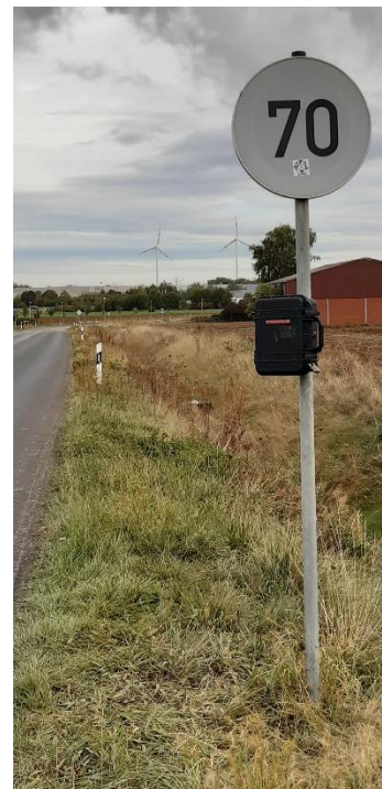
Abbildung 2: Befestigung des Radargerätes an der Weisweilerstraße
