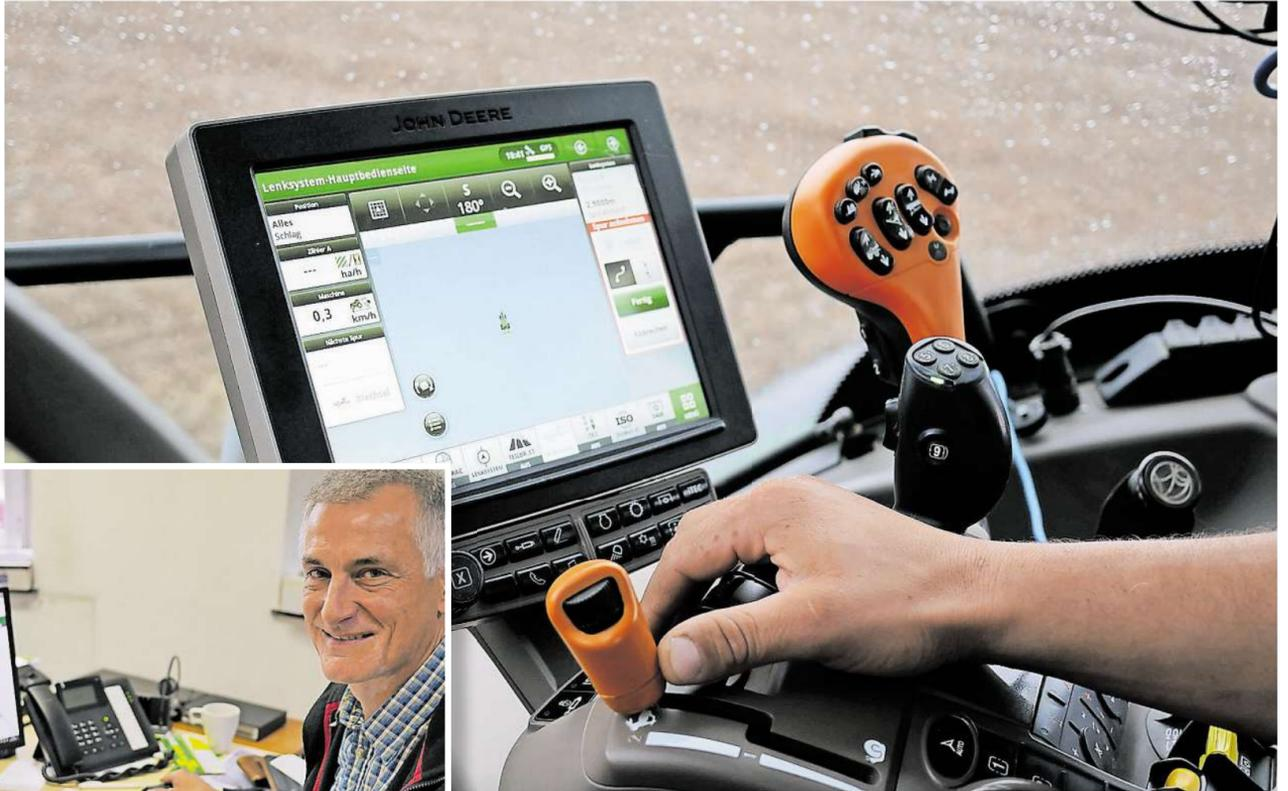
Cockpit eines Hightech-Traktors mit Bordcomputer, Terminal und automatischem Lenksystem. Das kleine Bild zeigt Andreas Dering, Geschäftsführer des Maschinenrings Rheinland-West, der seinen Mitgliedern bei der Digitalisierung hilft.
