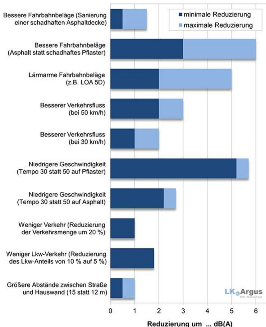
**Bild 6: Lärminderungspotenziale verschiedener Maßnahmen im Straßenverkehr** (Quelle: MULNV NRW, [http://www.umgebungslaerm.nrw.de/laermaktionsplanung/massnahmen\\_welche/index.php](http://www.umgebungslaerm.nrw.de/laermaktionsplanung/massnahmen_welche/index.php))
